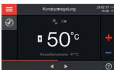
Display der Vitotronic 100 Kesselkreisregelung (Typ CC1E) mit Farb-Touch-Display für den angehobenen Betrieb
